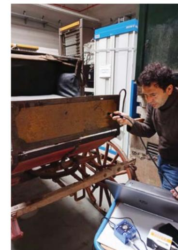
Konservierungswissenschaftler Andrea Macchia analysiert mithilfe eines portablen Raman-Spektrometers die Zusammensetzung von Farbschichten
