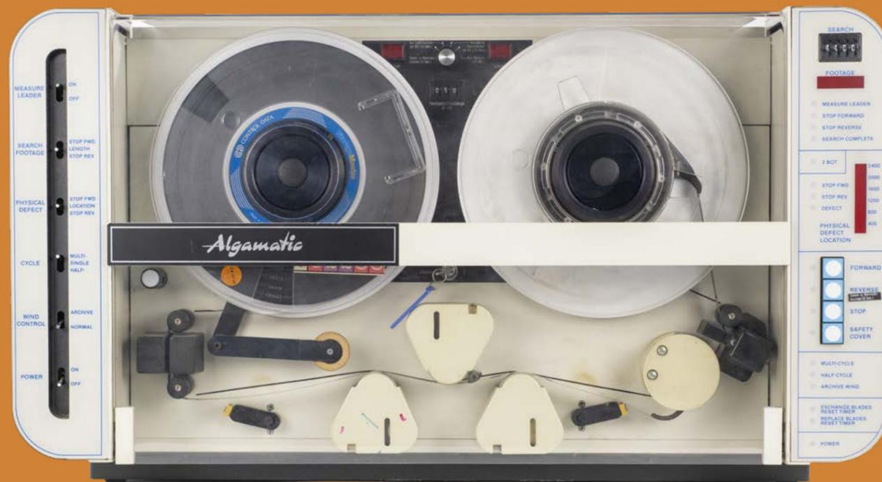
Mit der Speicherung von Daten geht auch der Wunsch nach Kontrolle und sicherer Löschung einher. Dieses Datenlöschgerät Robby-Bit MF aus dem Jahr 1979 löscht die Magnetbänder mithilfe eines Elektromagneten innerhalb von drei Sekunden und ermöglichte so die unbedenkliche Wiederverwertung der damals sehr teuren Datenträger.
